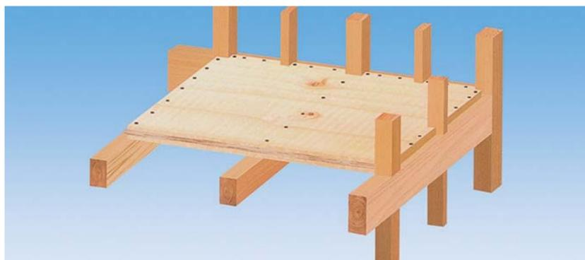
1階、2階の床は厚さ28mmの構造用合板を使用、地震に強い「剛床工法」採用。
