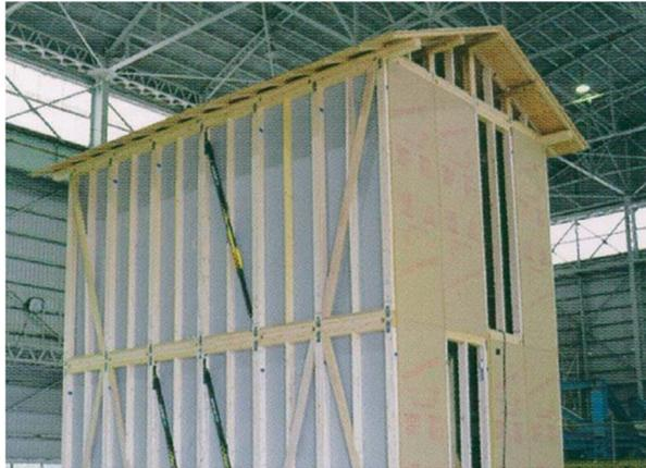
金属流動を利用した次世代型制震ダンパー「ミューダム」は、地震による振動エネルギーを熱エネルギーに変換する、画期的な制震ダンパーです。
